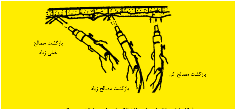
شکل ۱۱-۵ تاثیرات زاویه افشانک با دیوار در بازگشت مصالح
